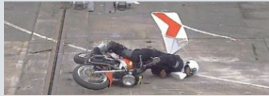
Collision d'une personne contre le poteau au niveau de la tête/du cou/de la poitrine
